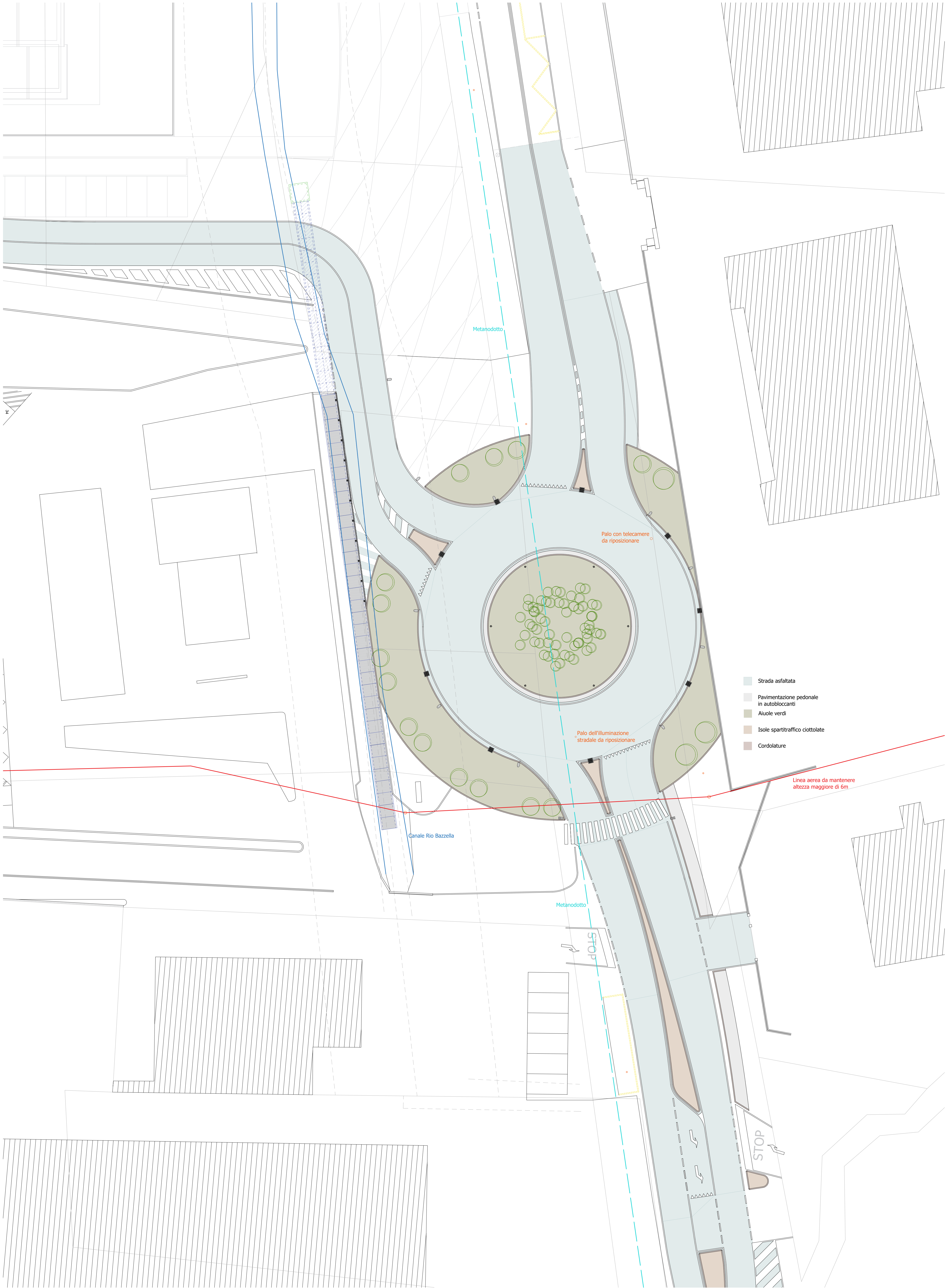
Individuazione delle interferenze Rilevo delle interferenze su planimetria di progetto Scala 1:200
